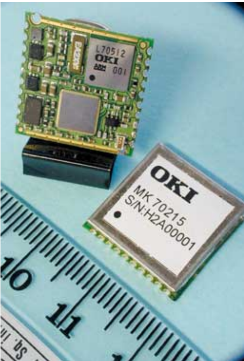
Le MK70215 d'Oki: un module CMS classe 2 avec 384 Ko de Rom masquée et disposant d'interfaces Uart et PCM.
